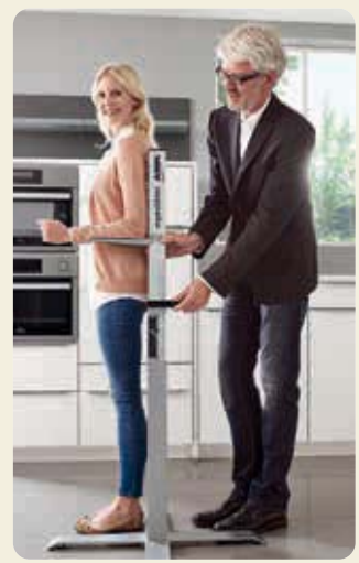
Entscheidend für die richtige Arbeitshöhe bei den verschiedenen Tätigkeiten in der Küche ist nicht die Körpergröße, sondern der Ellenbogen. Mit einem modernen Messgerät kann die ergonomisch richtige Arbeitshöhe exakt und schnell ermittelt werden..
